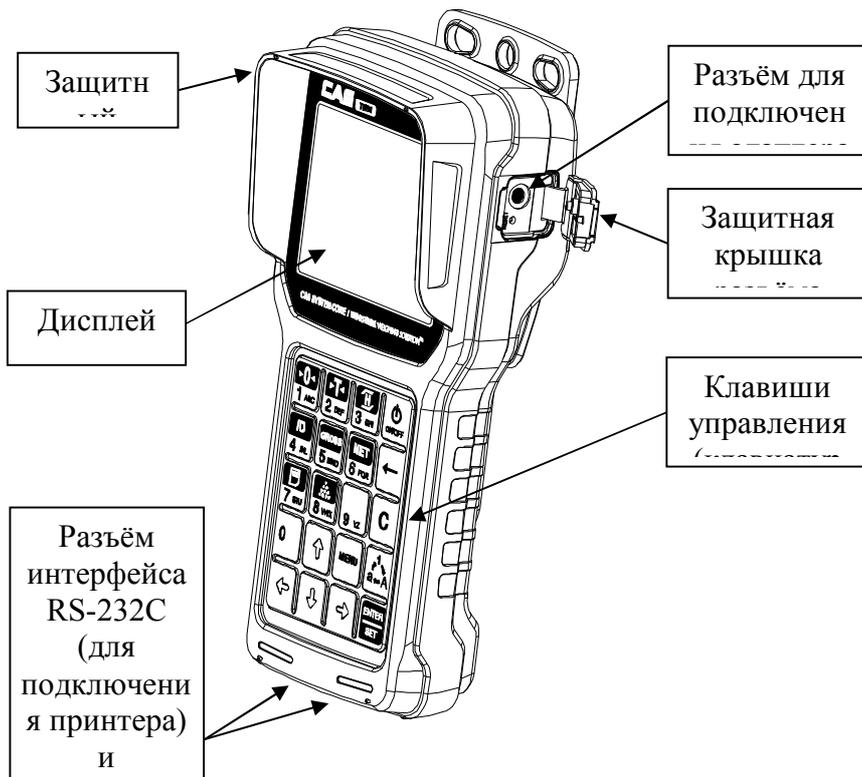
Рисунок 4.1 – Общий вид пульта TWN и обозначение основных элементов
