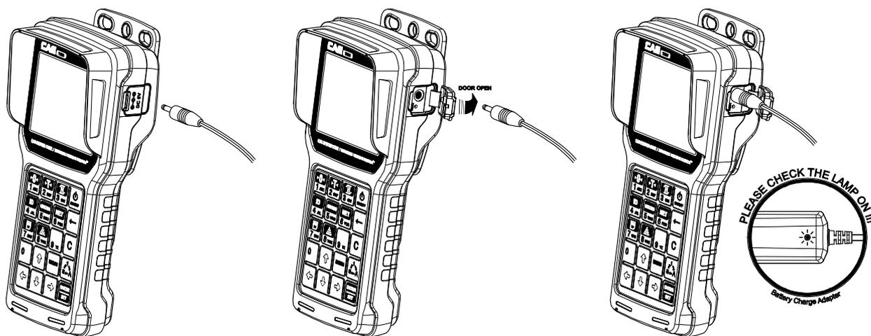
Рисунок 7.1 – Подключение адаптера для зарядки аккумулятора
